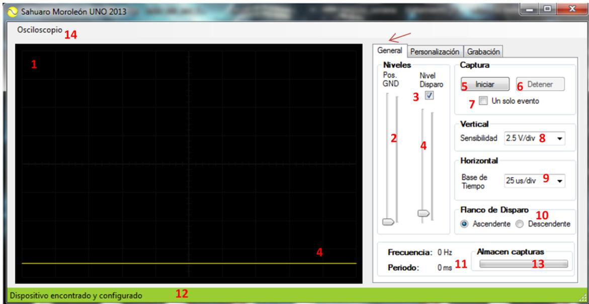
1.- Pantalla de lectura: Esta zona cuenta con las escalas apropiadas para mostrar la señal que se esta midiendo conforme los valores de división de voltaje y de tiempo (estos ajustes se describen mas adelante). Básicamente en esta pantalla se mostrara la señal para visualizar su forma de onda y características.
