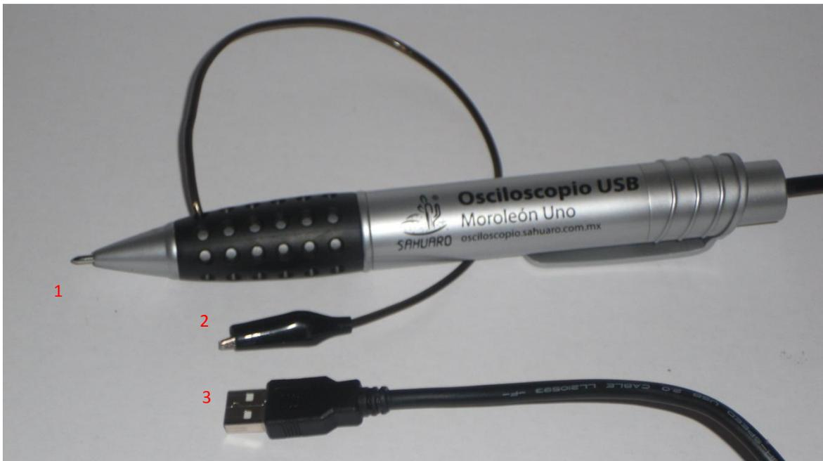
1.- Punta de medición del Osciloscopio Moroleón UNO: En esta debe estar conectada o ser posicionada sobre la fuente de la señal que se desea medir.
