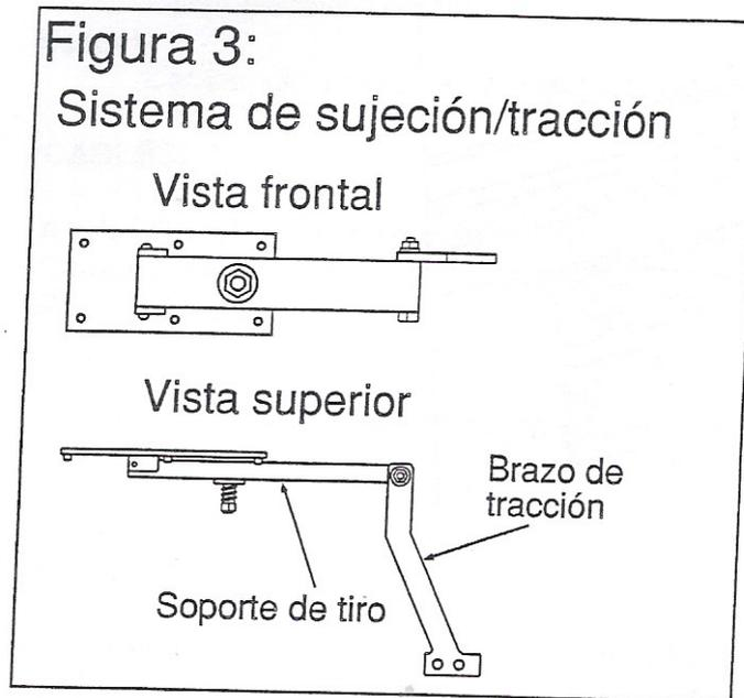
Para fijar la “distancia X” (Ver FIGURA 4) se debe tener en cuenta que esta **NO** debe ser mayor a 15 cm., para poder lograr esto, tal vez necesite cortar y resoldar el brazo de tracción.
