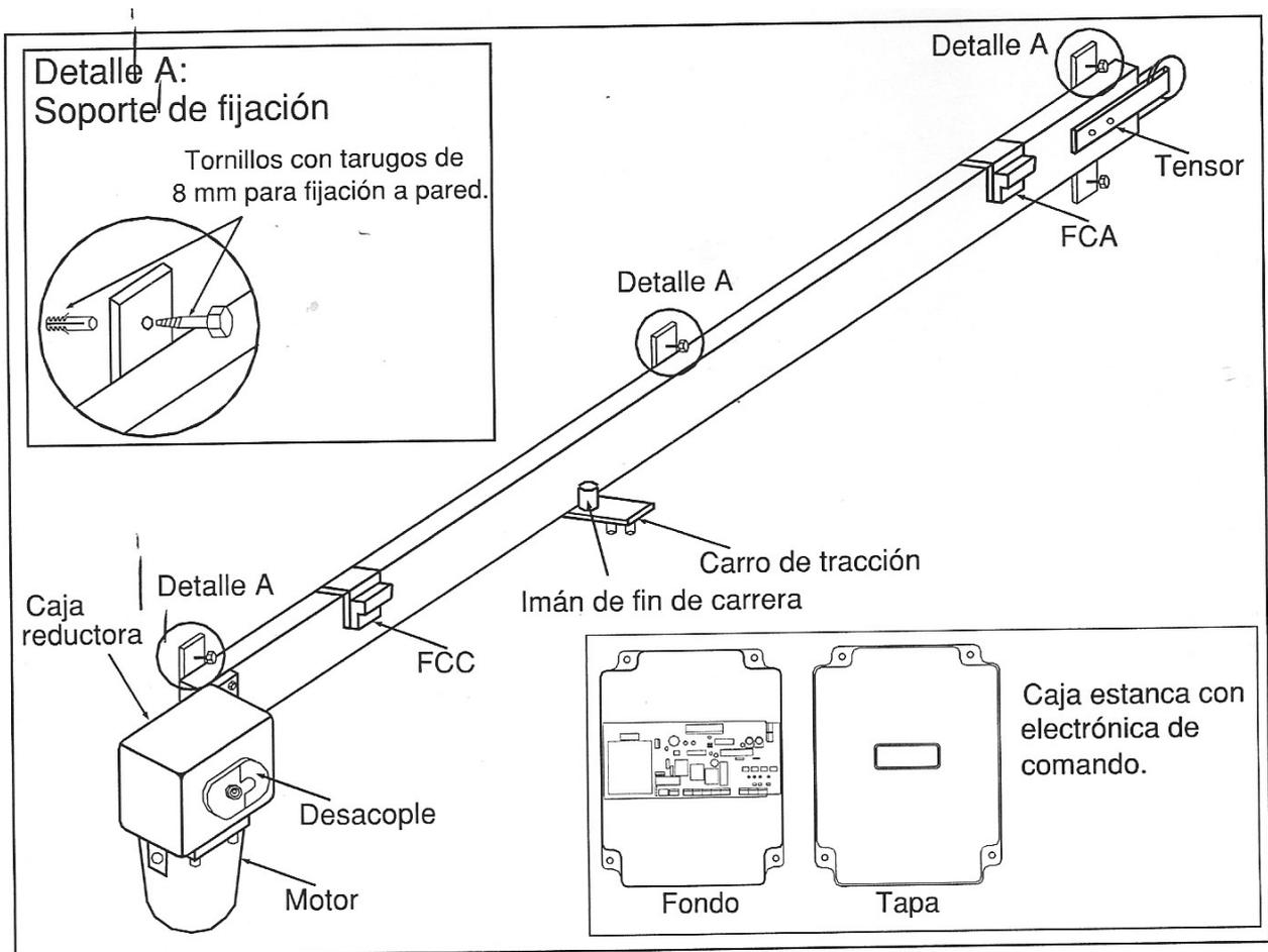
El motorreductor se fija en la parte inferior de la guía superior del portón a su estructura o a la pared por medio de tarugos.
