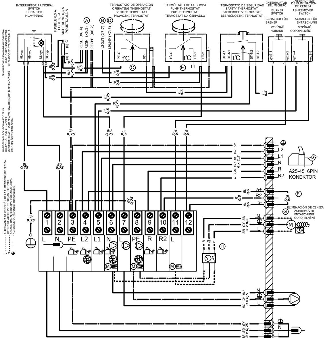
**PARA CONECTAR LA REGULACIÓN ELECTRÓNICA ADC01 Y QUEMADOR DE PELLETS A2545 HAGA ESTOS CAMBIOS**
