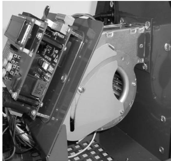
Ventilador del mechero con la válvula de aire. Abriendo la válvula de aire abreviamos la longitud de la llama.
