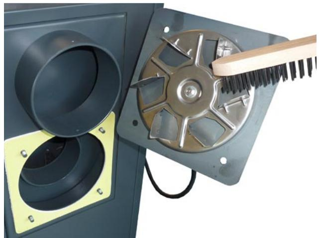
La muestra de la limpieza del impulsor y el control de la verticalidad de las paletas del ventilador del tiramento (en la caldera D31P)
