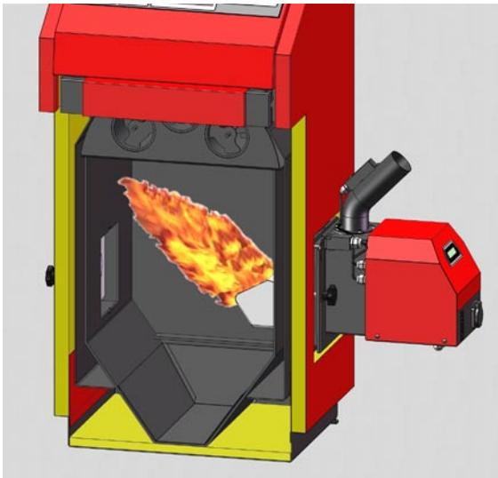
Llama del mechero que termina a 1 – 3 cm delante de la pared de enfrente.
