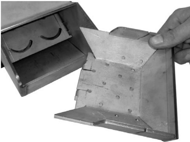
Cámara de combustión retirable con orificios para la aducción del aire – hay que limpiarla regularmente.
