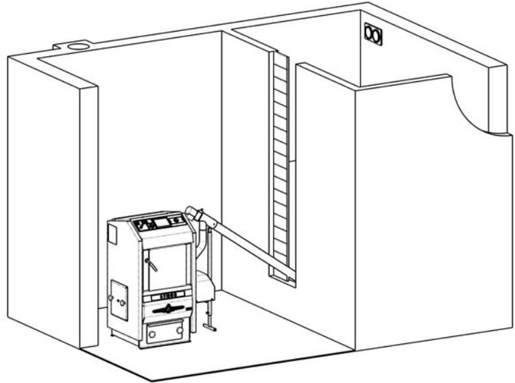
Para el vertido óptimo de peletas, el ángulo de las paredes interiores en el depósito debe ser por lo menos  $45^\circ$ . Todas las paredes se dirigen al punto inferior del depósito, donde las recoge el transportador de tornillo sin fin.
