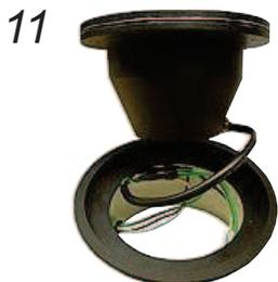
Enrolle el Cable al Rededor del Luminario. Siga la forma NATURAL para enrollar el Cable en Torno al Luminario sin Estrangular el cable. Finalmente Introduzca el Luminario en La Carcaza, Ubique bien los agujeros de Fijación y Atornillelo.
