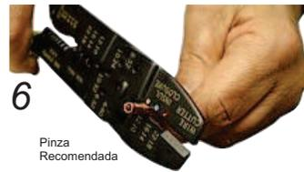
**6** Estrangule el extremo Inferior del conector. **SOLO** estrangule el extremo donde se encuentran los 2 cables, de entrada y salida de la Carcaza.
