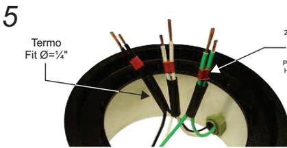
Acomode los cables en Pares, según el color; y coloque el Termo Fit Ø=1/4". **NO SUSTITUYA LOS FORROS TERMO FIT POR OTROS**, Los Forros Termo Fit suministrados por Prommsa cuentan con un Adhesivo Interior, lo cual favorece la hermeticidad de la conexión.
