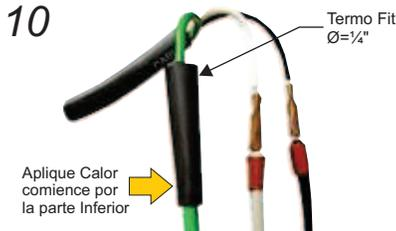
Coloque el Termo Fit Centrado al Área de Conexión. Es importante que el Termo Fit cubra perfectamente TODA la conexión.
