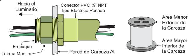
Deslice el Empaque de 3 Vías a través de los cables, e introduzcalo en el Conector de PVC. 1ero se introduce el extremo de Menor Área del Empaque, y el de mayor área queda hacia el interior de la Carcaza.
