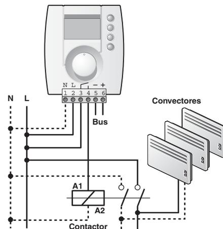
**Atención :** algunos contactores generan importantes parásitos que pueden alterar el funcionamiento del termostato. En ese caso, se recomienda cablear a los bornes de la bobina del contactor un auxiliar antiparásito 220V de tipo RC (ver catálogo fabricantes).
