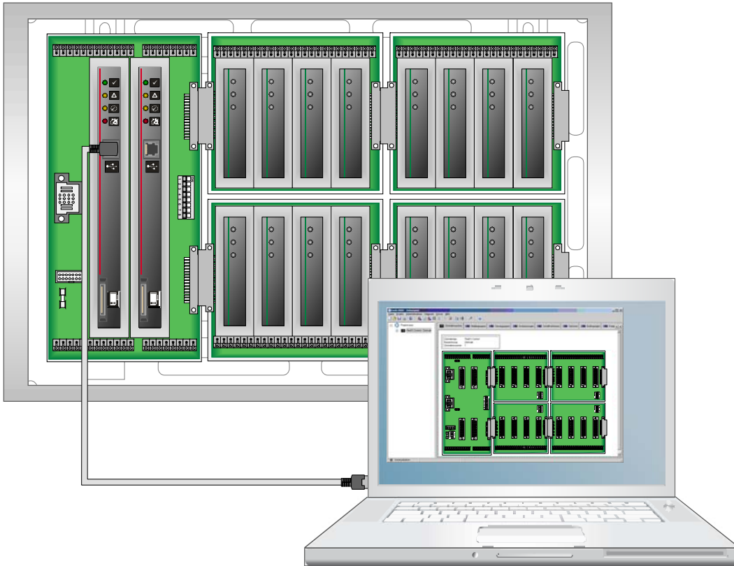
Fig. 3: PC de mantenimiento → al puerto USB de la central, situado en el 1er módulo de control CPU
