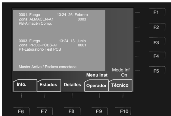
Fig. 36: Detalles con línea de redundancia de CPU Redundante
