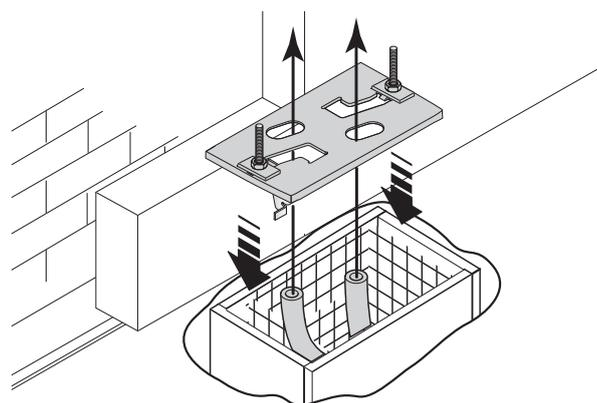
Para la colocación de la placa respecto de la cremallera, respetar las medidas indicadas en el dibujo. Llenar el encofrado con cemento y esperar por lo menos 24h hasta que se solidifique.
