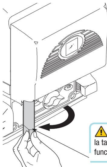
**⚠ ATENCIÓN:** la apertura de la tapa de desbloqueo, impide el funcionamiento del motor.
