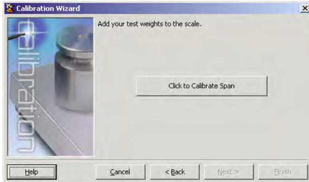
Figura 5-7. Pantalla iRev de Calibración de Amplitud
