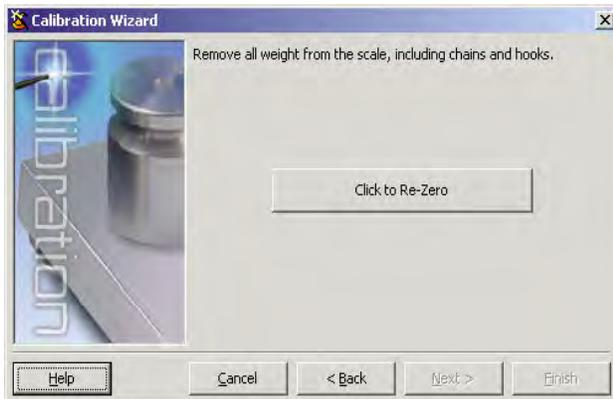
Figura 5-8. Pantalla iRev de Recalibración del Cero
