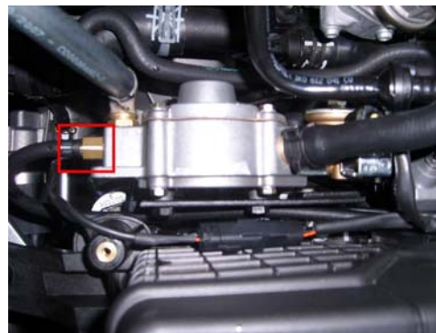
Toma de gas del evaporador
