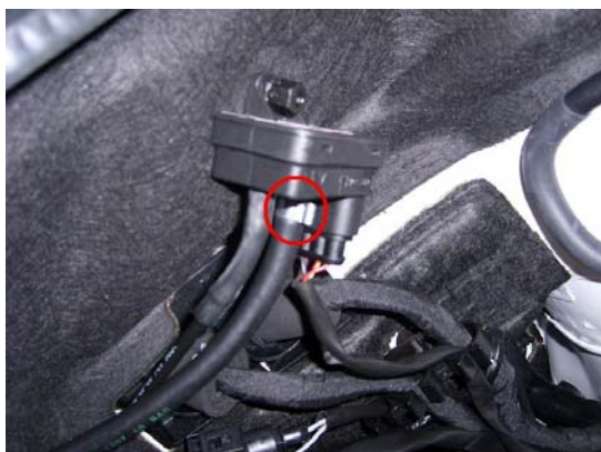
Toma de gas del sensor de presión
