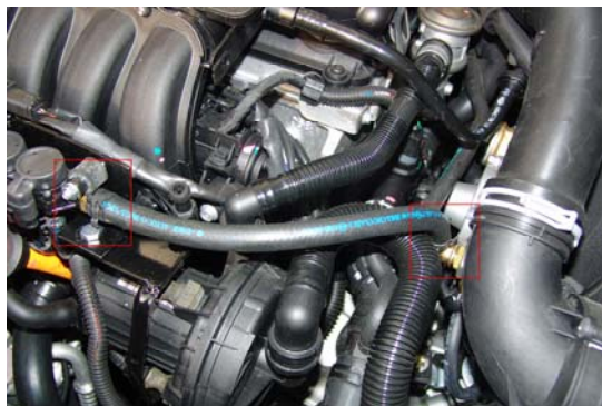
Salida de gas del evaporador y entrada en el bloque de inyectores
