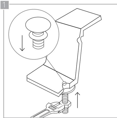
1 Inserte el sifón de su preferencia por el orificio correspondiente (M) y realice una impermeabilización con silicona anti hongos en el punto de contacto con el lavamanos de resina. Asegúrese de que no se presentan fugas entre los dos componentes.
