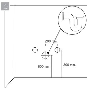
Verifique que la altura desde la superficie del piso terminado hasta el eje del sifón sea de 600 mm, y de 800 mm hasta los ejes de los abastos de agua fría y caliente. Asegúrese también que la separación entre dichos abastos sea de 200 mm.
