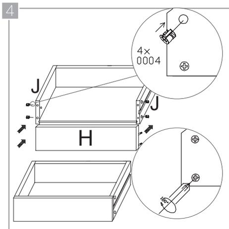
Inserte los salientes de los tornillos planos en los orificios que encontrará en los paneles laterales del cajón interior (I). Verifique que el acanalado interno coincide. Ajuste insertando 4 tensores (0002) en los orificios correspondientes y gírelos  $\frac{1}{4}$  de vuelta con un tornillo de pala.
