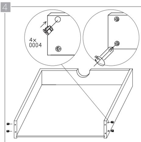
Verifique que el fondo del cajón (K), se acopla al acanalado interno del panel frontal (A) y fije este último en su posición insertando 4 tensores en los orificios indicados. Ajuste girando con un tornillo de estría  $\frac{1}{4}$  de vuelta.
