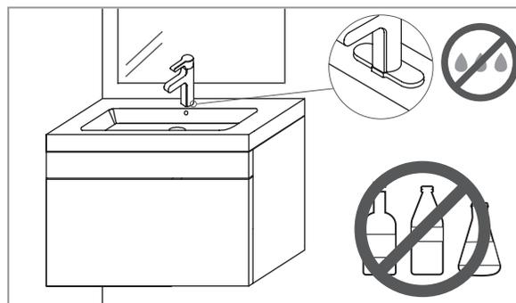
Verifique periódicamente que no se presenten fugas en las conexiones hidráulicas. Todos los goteos o filtraciones deben corregirse lo antes posible. Las maderas de nuestros muebles son tratadas con compuestos anti fúngicos e inmunizantes. No es necesario lacarlas, impermeabilizarlas ni tratarlas con ningún tipo de agente químico u orgánico.
