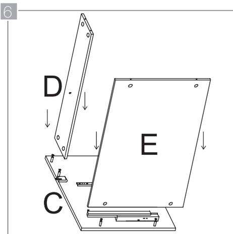
Inserte la parte superior de los tornillos planos (0001) que se encuentran en el panel lateral (C) por los orificios en los cantos del travesaño superior (D). Repita este proceso con la base del mueble (E).
