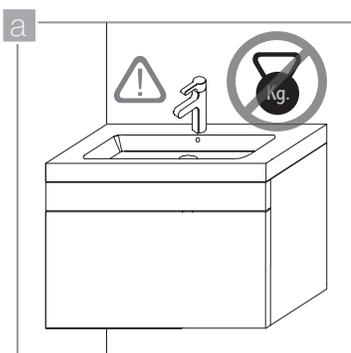
Verifique que la pared en donde ubicará el mueble lavamanos se encuentra totalmente seca, adecuadamente impermeabilizada, seca y con la capacidad portante suficiente para tolerar el peso del mueble y de los elementos que serán guardados en él.
