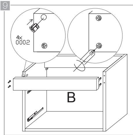
Inserte los tornillos fijados en el panel frontal (B) en los orificios ubicados en los cantos de los paneles laterales (C). Inserte dos tensores a cada lado, de manera que queden a tope con la madera. Gírelos  $\frac{1}{4}$  de vuelta con un destornillador de estría. Verifique que todo el conjunto quede firme.
