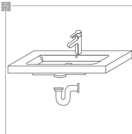
5 Las trampa P convencionales pueden impedir el cierre correcto de los cajones de su mueble. Conecte los sifones del lavamanos y de la pared utilizando un desagüe flexible. Instálole siguiendo las instrucciones del fabricante.
