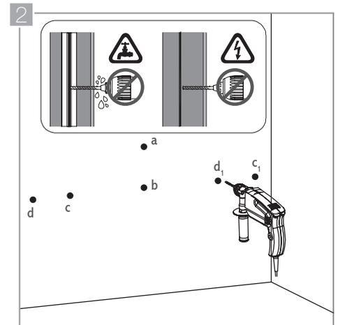
Utilizando un taladro y una broca de tungsteno, perfora la pared en los puntos a, c, d, c<sub>1</sub> y d<sub>1</sub>, e inserte los chazos plásticos suministrados en dichos orificios hasta que queden a tope. Tenga cuidado de no perforar tuberías de agua ni conductos eléctricos o de gas.
