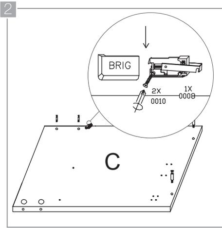
Tome una de las abrazaderas a pared (0008), desmóntela su cobertura exterior y ubíquela en el sitio indicado con dos tornillos de 22 mm. (0010). La muesca de la abrazadera debe apuntar en el mismo sentido de la flecha.
