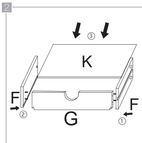
Inserte los salientes de los tabiques de madera en los orificios que encontrará en los cantos del panel posterior del cajón exterior (G). Verifique que el acanalado de los tres paneles coincide y deslice el fondo del cajón exterior (K) a través de ellos. No utilice pegamento en ninguna de las uniones.
