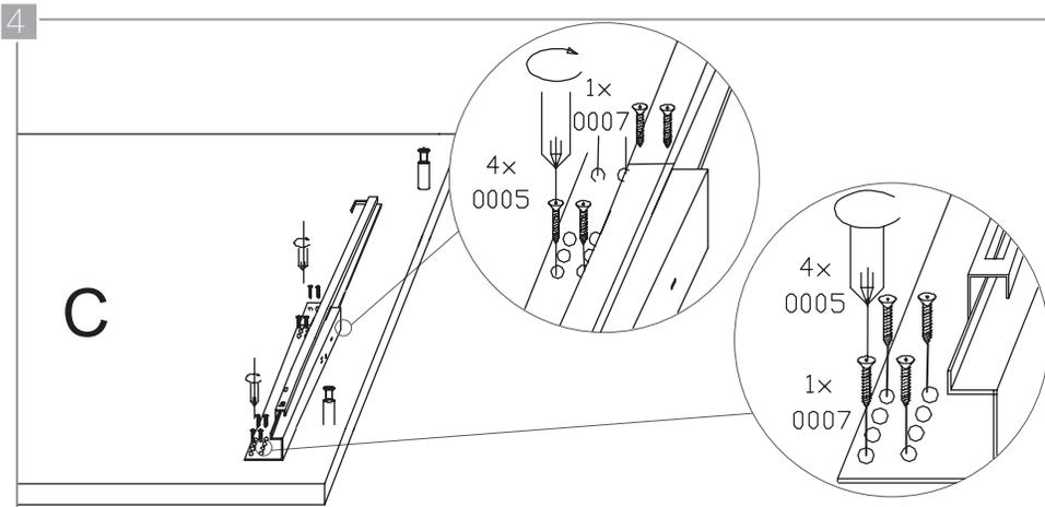
Ubique uno de los rieles del cajón inferior (0007) en el sitio indicado, de manera tal que sus orificios coincidan con los del tablero de la pieza. Fíjelo en su posición insertando 8 tornillos de 12 mm. (0005) en los sitios indicados. Verifique que los dos rieles se mueven de manera fluida y sin obstáculos y que todos los elementos se encuentran en su posición.
