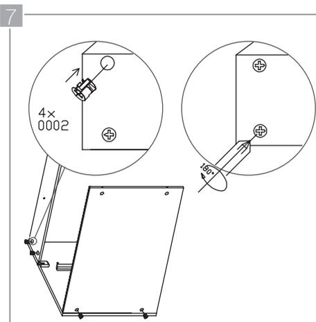
Fíjelo el panel lateral (C) a las piezas (D), y (E) insertando los tensores (0002) tal como se muestra en la imagen. Ajústelos girando con un tornillo de estría  $\frac{1}{4}$  de vuelta. Repita los pasos 6 y 7 para ubicar el segundo panel lateral (C).
