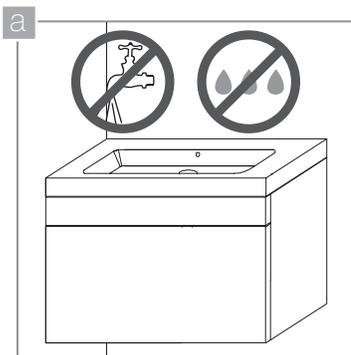
Los componentes de madera de su mueble lavamanos son de tablero aglomerado, recubierto con melamina y/o pintura de poliuretano. Esto incrementa su resistencia al rayado y a la decoloración, pero los hace sensibles a la humedad.
