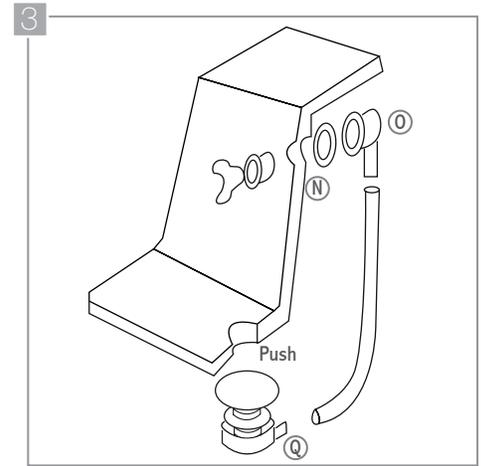
3 Finalice la instalación del acople del rebosadero y el sifón de acuerdo al gráfico. Antes de hacer el ajuste final, verifique que el orificio del sifón y el conducto del rebosadero están correctamente alineados, y refuerce con silicona anti hongos en los puntos indicados.
