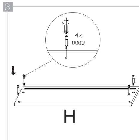
Ubique el panel posterior del cajón exterior (H) sobre una superficie plana y coloque 4 tornillos planos de 25 mm. (0003) en los sitios indicados. Gire con un tornillo de estría hasta obtener un ajuste firme, pero no excesivo.
