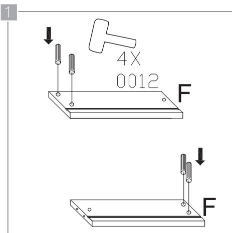
Ubique los dos paneles laterales del cajón exterior (F) en una superficie plana e inserte 4 tabiques de madera (0012) en los orificios correspondientes. Ajuste cuidadosamente golpeando con un martillo de goma. No utilice pegamento.
