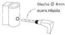
Dar profundidad sobre el agujero existente en la bisagra con una mecha de 4mm acero rápido.
