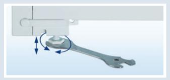
Las patas frontales son regulables en altura e imprescindibles para nivelar el aparato. Los modelos con una altura de 122 cm o superior - dependiendo del modelo y de la altura - tienen 2 o 4 patas regulables en el frontal.
