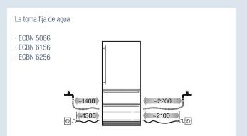
¡Se requiere toma fija de agua para el fabricador automático de cubitos de hielo (conexión tubo 3/4")! Como elemento accesorio especial hay disponible un tubo flexible blindado de 3 m. (Ref. 6030 785)
