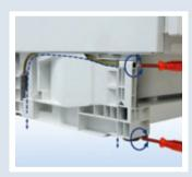
Con el zócalo Vario en los modelos UIK, UIG, UWT y UWK se consigue una perfecta adaptación al mueble en altura y profundidad. Las 4 patas se pueden regular en altura hasta 50 mm desde la parte frontal. El zócalo también se puede desplazar en horizontal hasta 55 mm para quedar en línea con los muebles.
