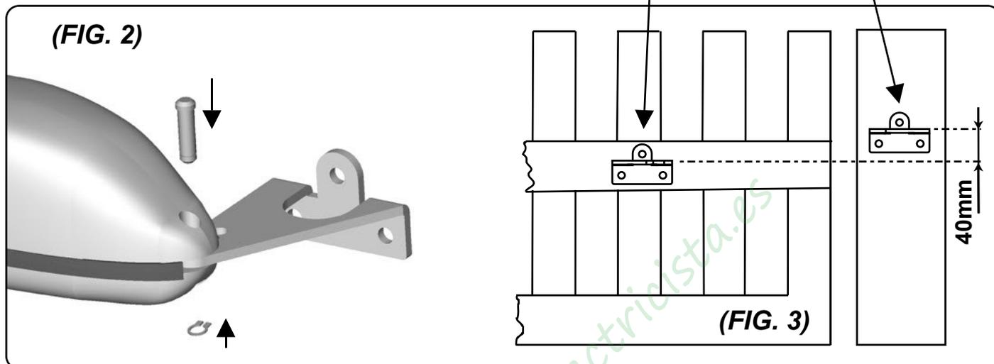
**Atención!** Al determinar la altura del suelo a la placa (Fig.1) que va en la pared, tener en cuenta que el soporte delantero del motor en la puerta irá 40 mm más bajo del nivel posterior para conseguir la horizontabilidad del operador. (FIG.3)
