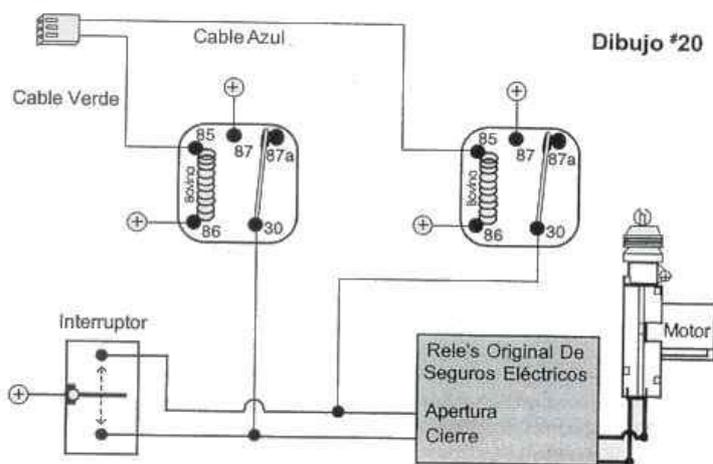
Conexión De Seguros Eléctricos Tipo "Positivo" Usando Un DLP-P3
