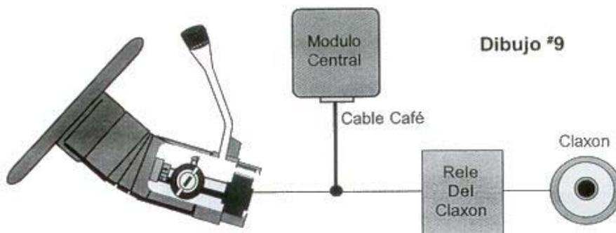
Nota: para este tipo de conexión es necesario que el Claxon funcione con la ignición del vehículo apagada. Si el Claxon no funciona con la ignición apagada, es necesario usar un relé externo para operar el Claxon directamente (Dibujo # 10).
