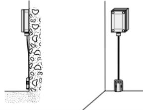
**Nota:** para facilitar el mantenimiento, la sonda es móvil. Es aconsejable limpiarla periódicamente para evitar la acumulación de polvo entre la sonda y el suelo.
