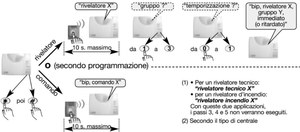
Tenete premuto il pulsante di test del trasmettitore universale fino alla risposta della centrale.
