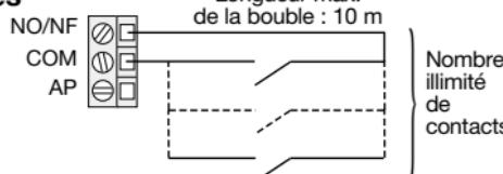
**ATTENTION : le raccordement d'une boucle autoprotégée doit être effectué avant le branchement de la pile. La reconnaissance de cette dernière se fait alors automatiquement lors du branchement de la pile.**
