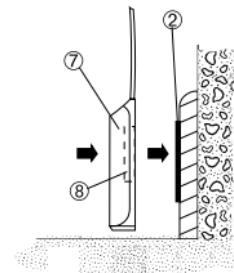
Pour une sonde posée verticalement, le trou de fixation de la plaque métallique doit être en haut.
