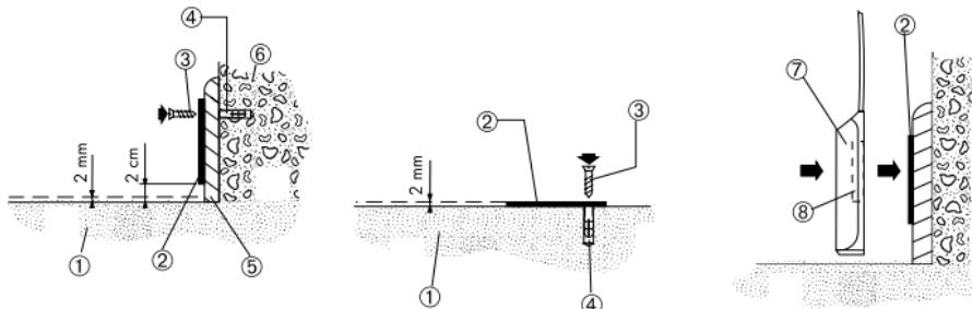
Para una sonda colocada verticalmente, el agujero de fijación de la placa metálica debe estar en la parte alta.
