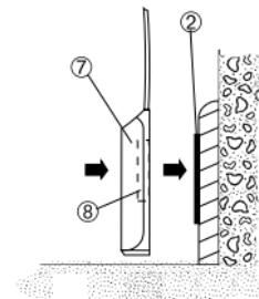
Nel caso di sonda fissata verticalmente, il foro di fissaggio sulla placca metallica dovrà essere posizionato in alto.
