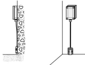
**Nota:** per facilitare la manutenzione, la sonda è mobile, si consiglia di pulirla periodicamente per evitare l'accumulo di polvere tra la sonda ed il pavimento.
