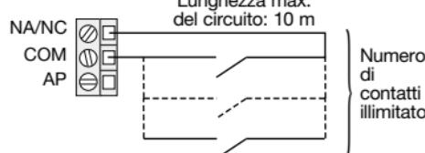
**ATTENZIONE:** Il collegamento di un circuito di autoprotezione deve essere effettuato prima del collegamento della batteria. Il riconoscimento della presenza di tale circuito avviene infatti al momento del collegamento della batteria.
