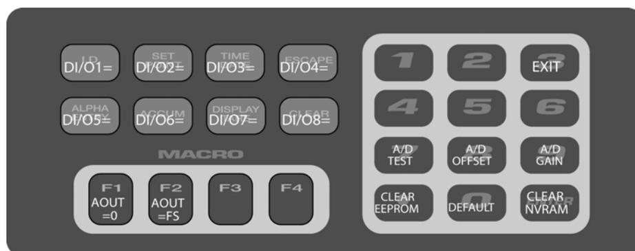
Figure 10-5. Funciones de Las Teclas del Panel Frontal en el Modo de Prueba
