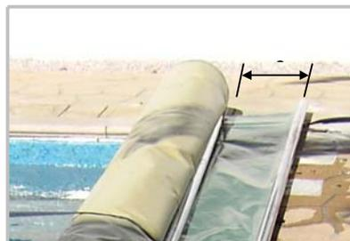
Extender todas las cintas, respetar la posición de las piquetas y taladrar con la broca Ø12 mm., Clavar las piquetas con el martillo y enganchar a éstas los anillos de las cintas.
