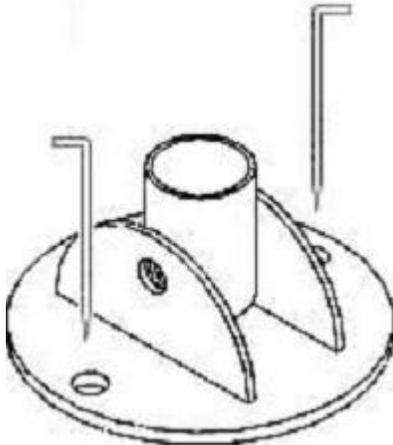
3. Ponga el pie del mástil en la abertura en la base, y la parte superior en un caballete o un soporte parecido (altura=700mm). Instale la abrazadera a aproximadamente 1.5m de la cima del mástil, apretando los pernos.
