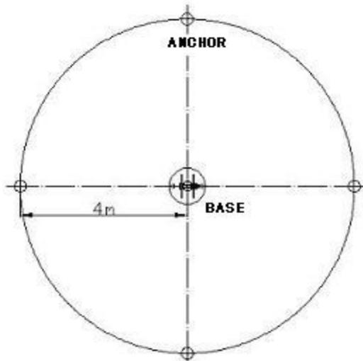
Si el suelo está blando, construya por favor una base de homigón para la base del mástil y las anclas (profundidad=500mm, ancho=400mm).
