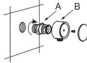
2- Enrosque el adaptador (A), luego coloque la campana (B) deslizándola con una leve presión sobre el adaptador (A). Fije la campana (B) con el tornillo, luego coloque la tapa a presión sobre el conjunto.
