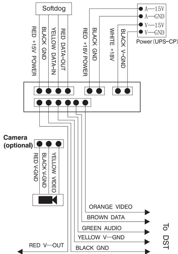
• **DIAGRAMA DE CABLEADO PARA EL CENTRO DE MANEJO CON ESTACIÓN EXTERIOR.**
