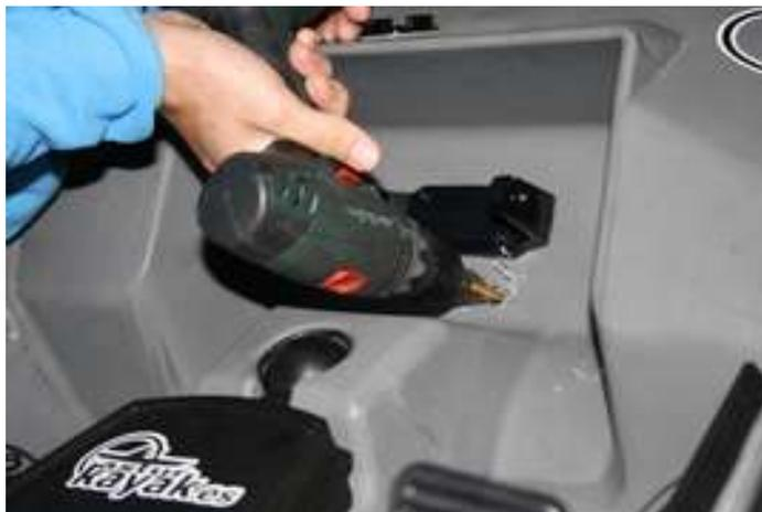
Para el cable del transductor repetiremos la operación en la parte inferior izquierda, esta vez con una broca de 16mm. Esta medida es la mínima para que el conector del transductor pase del interior al exterior sin cortar el
