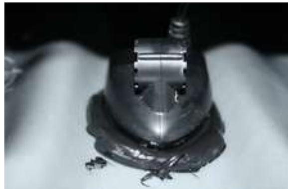
Para una buena transferencia de la información a la hora de poner el sikaflex el casco ha de estar limpio y seco. Secar durante 48 horas.
