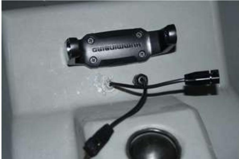
Las **instrucciones** de la sonda indican que para que la garantía se cumpla deberá de haber un fusible de hasta 3 A entre la sonda y la fuente de alimentación. Vamos a ello.
