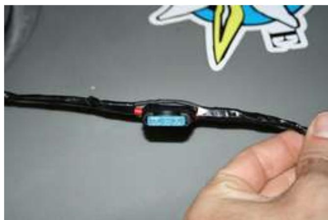
Solo nos queda instalar los cables al conector para poder enchufar la batería. Conectaremos el rojo en la regleta que indica + y el negro en la que indica -. Le pondremos cinta aislante para una mayor durabilidad.
