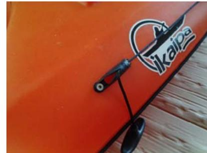
En cambio si queremos elevar y fijar nuestro timón como por ejemplo para transportarlo o para una excursión que no lo queremos utilizar, el kayak dispone de un sujeta timón fijo en la parte trasera. NO se puede acceder a el desde la posición de paleo
