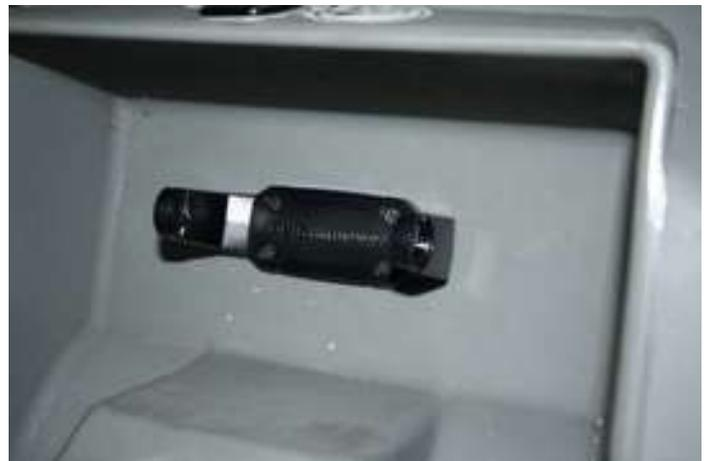
Si queremos colocar el soporte de la batería, desatornillaremos los tornillos hasta que por el interior del kayak solo se vean las 4 puntas de los tornillos, de esta forma podremos centrar el soporte. Una vez centrado, volveremos a atornillar uniendo el soporte de la sonda y el soporte de la batería al kayak.
