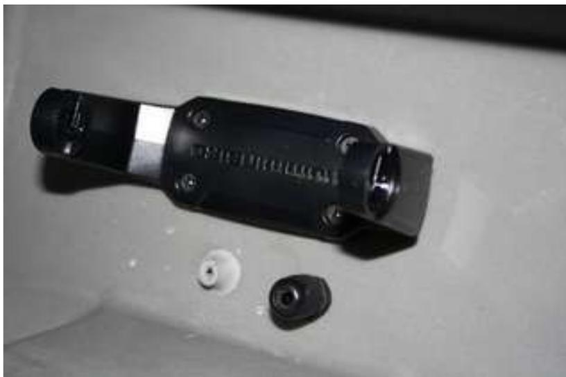
El cable de alimentación lo pasaremos por el prensaestopas de fuera adentro, en cambio el del transductor lo pasaremos de dentro a afuera. En
