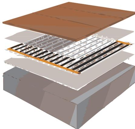
**El sistema directo** tiene la gran ventaja frente a los demás sistemas de suelo radiante de no necesitar utilizar el mortero como pulmón. Esto es ideal para climas con inviernos inestables, ya que podemos manejar la calefacción según nos convenga dado que tiene un tiempo de reacción muy corto ( 10-20 min. aprox.). Esto la convierte en la calefacción ideal para el clima mediterráneo.
