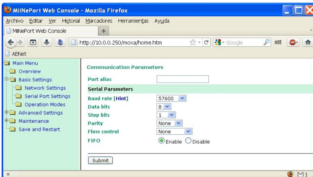
En **“Baud rate”** se debe fijar la misma velocidad de comunicaciones que se ha fijado en la personalización de la Central Algorítmica para el puerto RS-232 que vamos a utilizar. Por defecto se configura a 38.400 bps.
