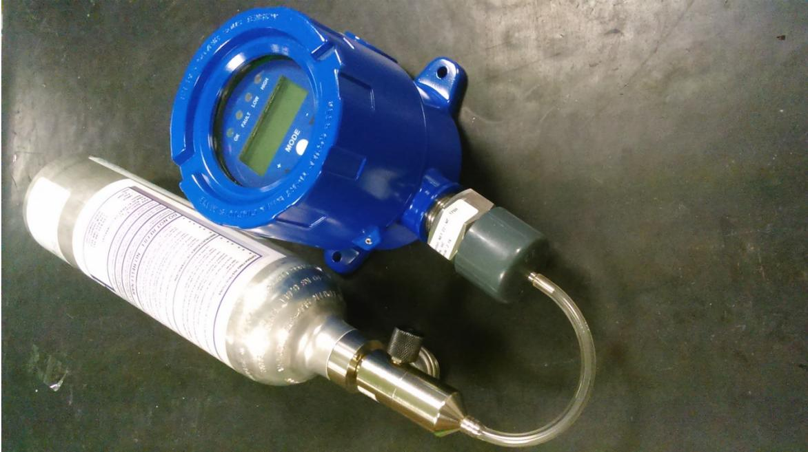
**Sensotox 2 conectado a un cilindro de gas de calibración con un adaptador.**
