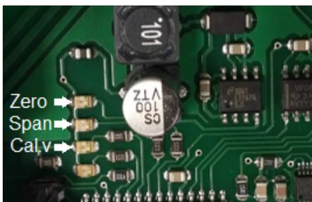
*LEDs calibración Sensotox 2 ciego.*
