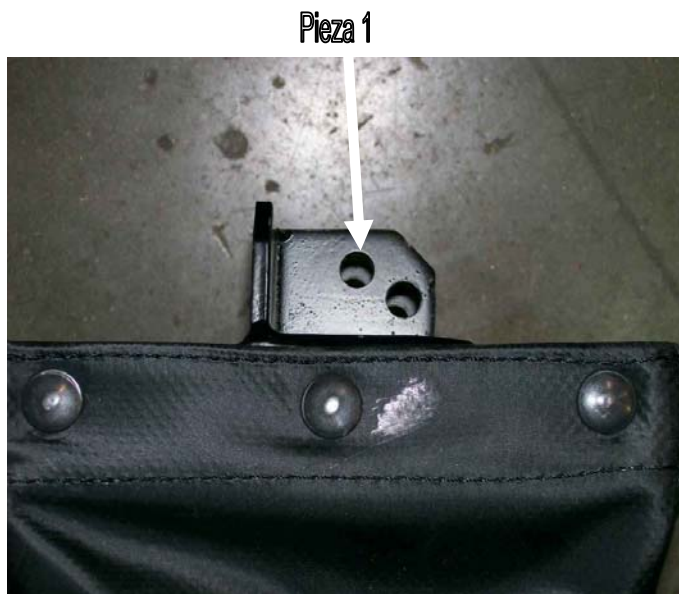
Figura 14. Armado e instalación de la bolsa de vinilo para la cadena
