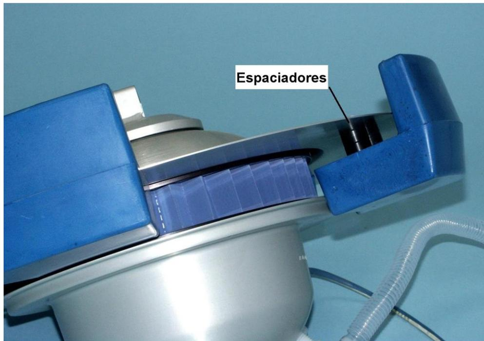
Figura 1-4 – Detalle del flotador (acomodado) para la posición de aguas turbulentas.
