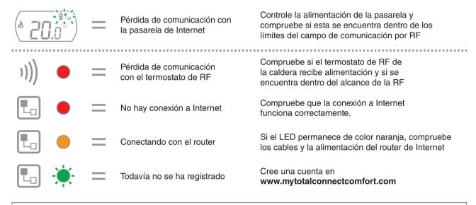
Comentario: La comunicación puede verse alterada por la presencia de obstáculos (objetos metálicos) o por una distancia excesiva entre el termostato y la pasarela de Internet.
