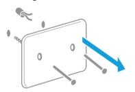
Atención: Este termostato no necesita cableado. Aísle los conductores e introdúzcalos en la pared.
