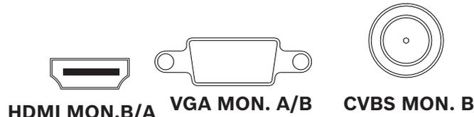
Figura 4.4 Conectores de monitor
