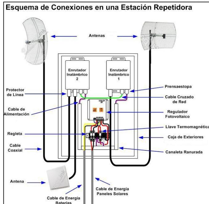
**SISTEMAS DE COMUNICACIÓN REPETIDOR DOBLE, componentes:**
