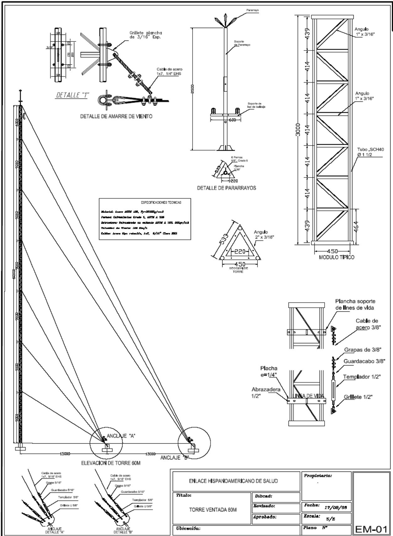
Estructura típica torre tipo B
