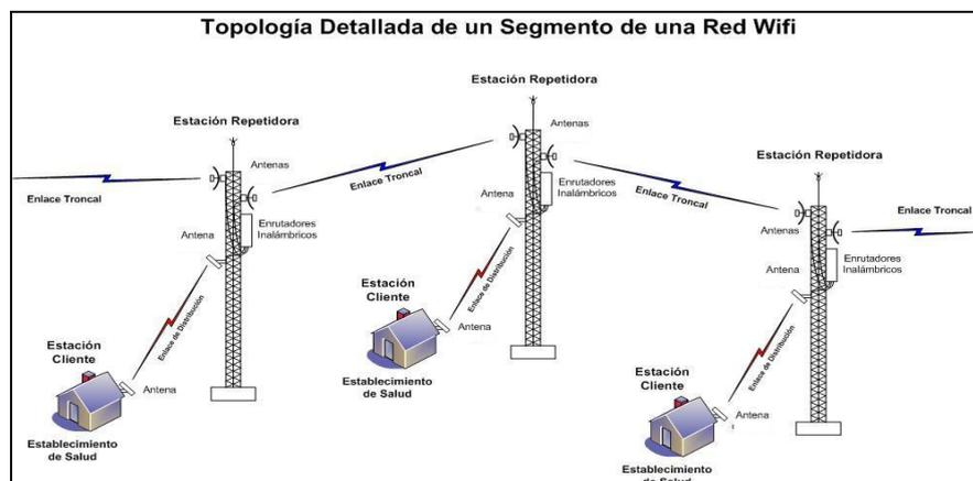
**Sistema de comunicaciones de un repetidor**
