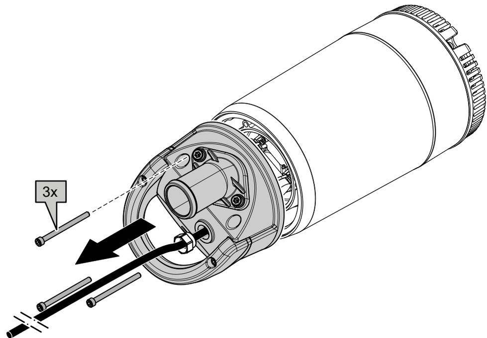
3. Desconecte el cable del motor de los terminales:
