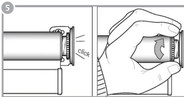
Luego engánchela en el soporte. Para sujetar la cortina, Gire el anillo tope contra la puntera regulable..
