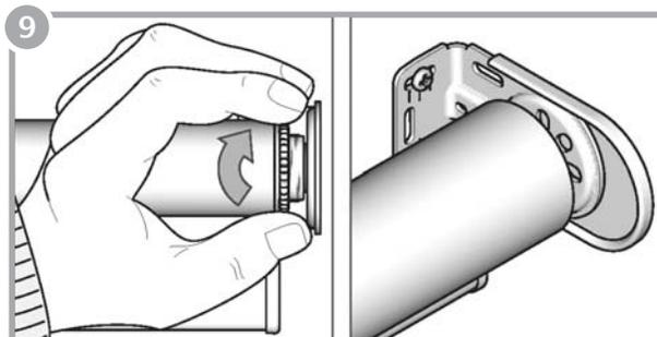
Para fijar la cortina, gire el anillo tope contra la puntera regulable. Deslice las tapas en los soportes.
