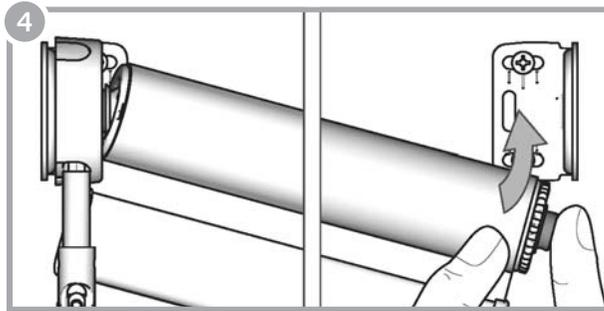
Coloque el adaptador de tubo en el centro de la manivela. Presione la puntera regulable y levante la cortina.
