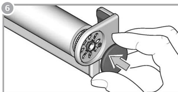
Inserte la tapa en el soporte de diseño.
