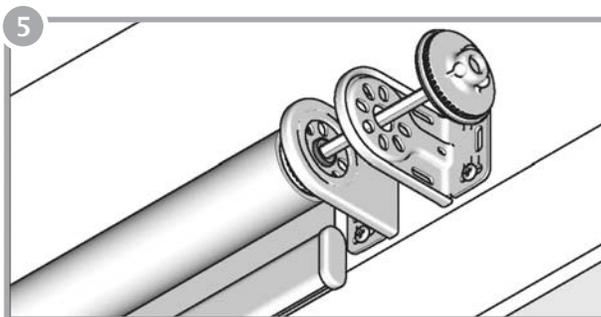
Solo en acoplamientos con 2 soportes intermedios. Sujete el soporte interno (con la tapa colocada) con los tornillos provistos. Deslice el alineador o el conector por el soporte en la puntera regulable.
