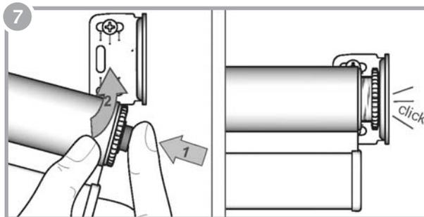
Presione el conector, levante la cortina y engánchela en el soporte.
