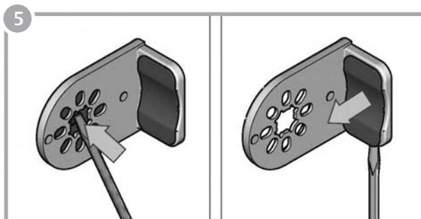
Separa la tapa del soporte de diseño.
