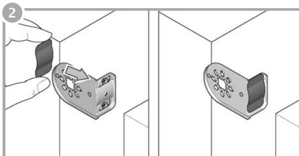
Deslice la cubierta del tornillo sobre el soporte hasta engancharla. Sólo cuando se utilicen soportes de diseño.
