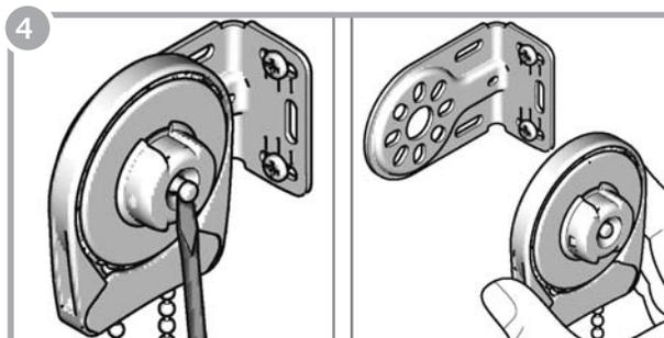
Coloque un destornillador debajo del pin del mecanismo y empuje hacia afuera. Quite el mecanismo del soporte.
