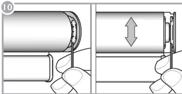
Para nivelar la cortina, inserte la llave Allen en el tornillo del nivelador y gírela hacia la derecha o hacia la izquierda para nivelar la cortina hacia arriba o hacia abajo. En cortinas de mayor tamaño, soporte el peso de la cortina con la palma de la mano.
