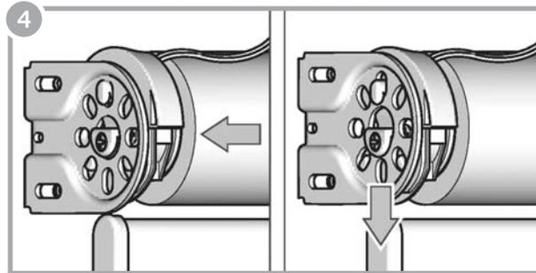
...hasta que la placa frontal del motor se enganche en el soporte. Presione la cortina con la placa frontal del motor hacia abajo.
