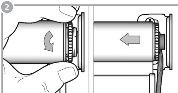
Afloje el anillo tope. Deslice un destornillador entre el anillo tope y el soporte y empuje la puntera regulable contra la manivela.
