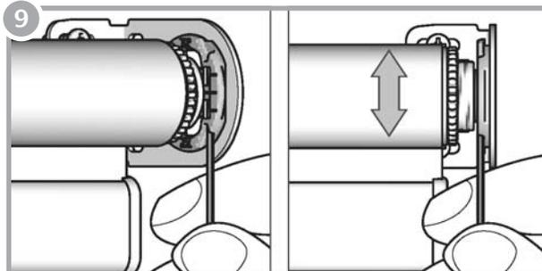
Para nivelar la cortina, inserte la llave Allen en el tornillo del nivelador y gírela hacia la derecha o hacia la izquierda para nivelar la cortina hacia arriba o hacia abajo.
