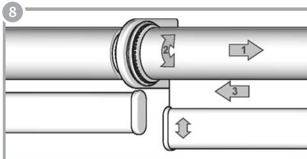
Para alinear ambas bases inferiores, empuje la cortina contra la puntera regulable (1), gire la cortina, nivele la base inferior con la otra base inferior (2). Suelte para fijar la posición (3). No es posible cuando se utilice un set conector.
