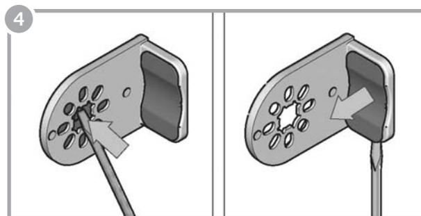
Presione en la cubierta para desengancharla del soporte de diseño. Utilice un destornillador para quitar la cubierta de los tornillos del soporte de diseño.
