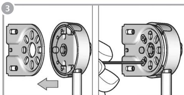
Coloque la manivela en el soporte y sujétela con ambos tornillos.
