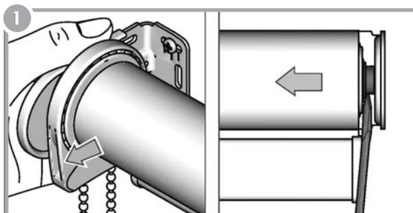
Deslice un destornillador entre la tapa de tubo y el soporte y presione en dirección del mecanismo. Deslice la tapa hacia usted.
