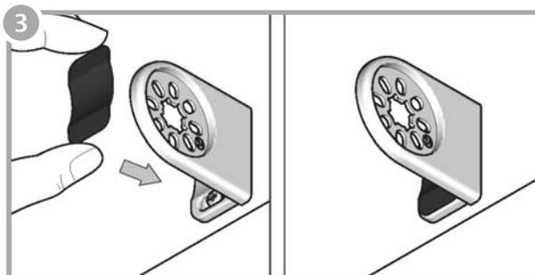
Deslice la tapa en el soporte (cuando se utilicen soportes de diseño).
