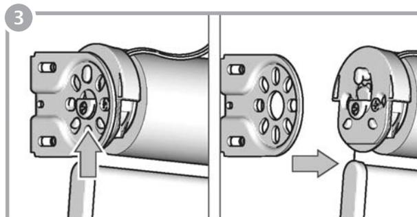
Levante la placa frontal del motor y sepárela del soporte.
