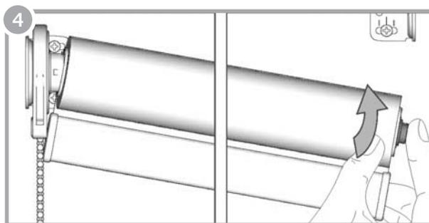
Coloque el adaptador de tubo en el centro del mecanismo. Presione la puntera regulable y levante la cortina.
