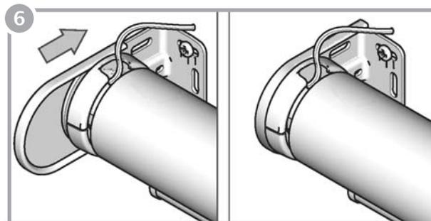
Deslice las cubiertas en los soportes.
