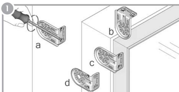
Sujete el soporte con los tornillos provistos
