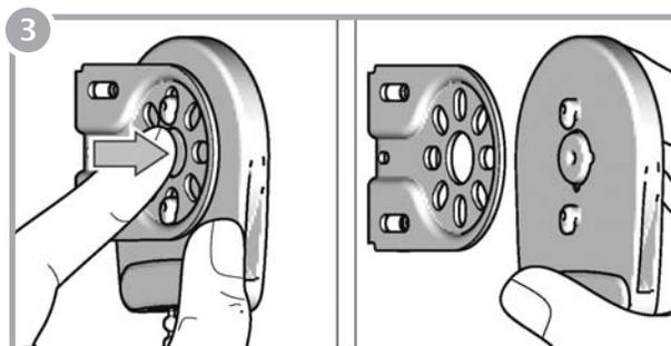
Presione el pin del mecanismo y quite el mecanismo del soporte.
