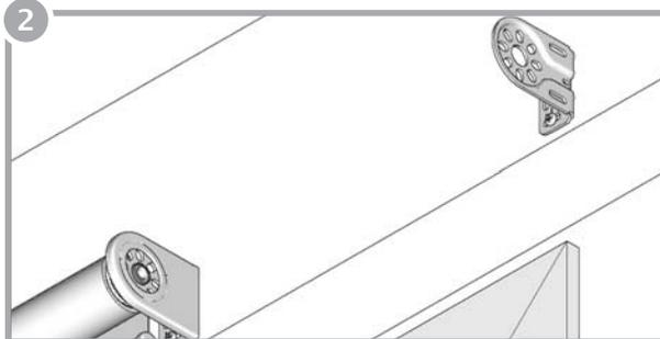
Sujete el soporte exterior con los tornillos provistos.
