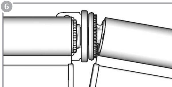
Coloque el adaptador del tubo en el alineador o el conector.
