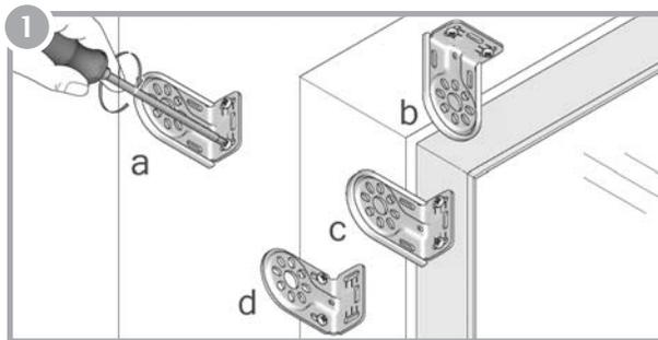
Sujete el soporte con los tornillos provistos.
