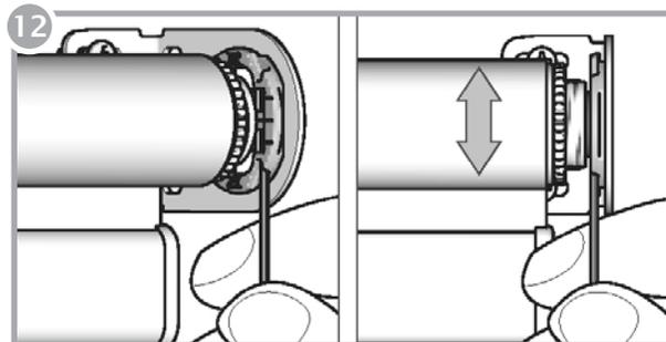
Para nivelar la cortina, inserte la llave Allen en el tornillo del nivelador y gírela hacia la derecha o hacia la izquierda para nivelar la cortina hacia arriba o hacia abajo.
