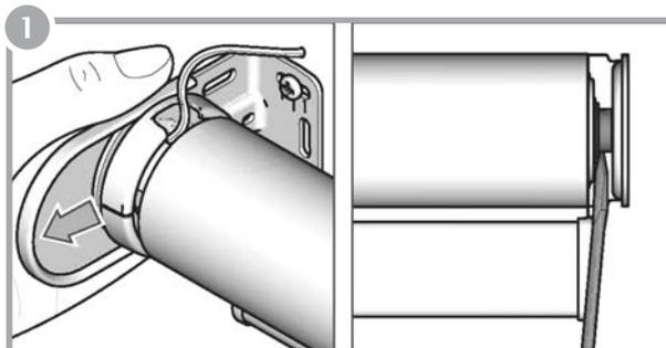
Deslice la tapa hacia usted. Desconecte el motor. Quite la cubierta de la placa frontal del motor. Deslice un destornillador entre la puntera regulable y el soporte y empuje la puntera regulable en dirección del motor.
