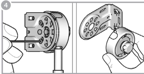
Afloje ambos tornillos y quite el mecanismo de la manivela del soporte.
