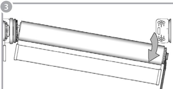
Mueva la cortina hacia abajo para desengancharla del soporte. Jale del alineador o conector para desengancharlo.
