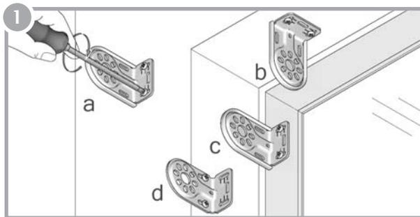
Sujete el soporte con los tornillos provistos.
