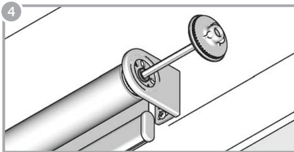
Deslice el alineador o el conector por el soporte y dentro de la puntera regulable.
