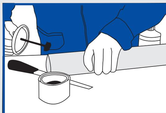
Una el Tubo con el Accesorio asegurándose de un buen asentamiento y déle un cuarto de vuelta para distribuir la soldadura, manteniendo firmemente la unión por 30 segundos .
