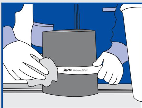
Es aconsejable tensionar el Tubo a medida que se dobla para evitar arrugas en la parte interior de la curva. Tan pronto la curva esté formada, debe enfriarse con un trapo mojado en agua fría.
