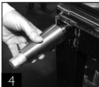
4 Atornille la pata en la parte inferior de la base del gabinete.
