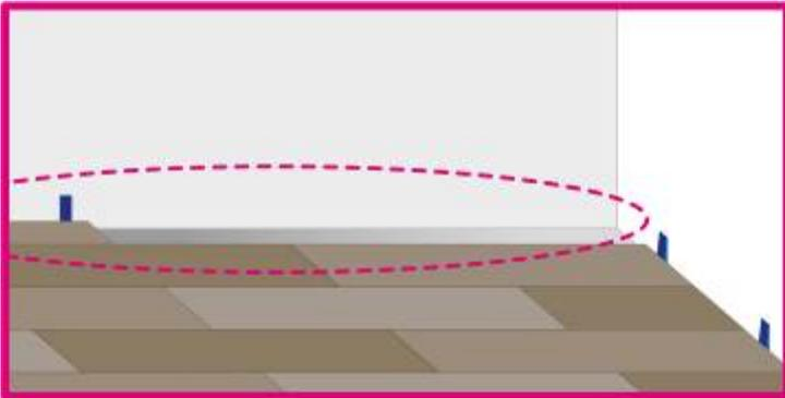
7a. Coloque un lama sobre la última lama instalada.
