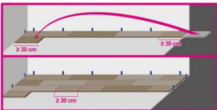
**Atención:** una vez que haya instalado la primera lama de la segunda fila, deberá ensamblar las siguientes laminas empezando siempre con la lengüeta de extremo corto (en azul en el dibujo). Antes de insertar la lama en la ranura lateral del lado largo (en verde en el dibujo), levantar ligeramente las dos laminas antes de presionar hacia abajo para encajarlas. Siga los siguientes pasos:
