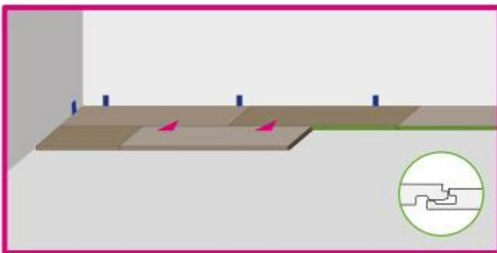
4c: Inserte las lengüetas de la segunda lama en la ranura de la lama de la primera fila. Tendrá que levantar un poco la primera lama para hacerlo
