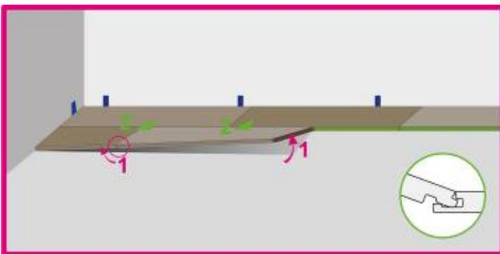
5: con el fin de completar la instalación, deberá presionar las lamas hacia el suelo para fijarlas.
