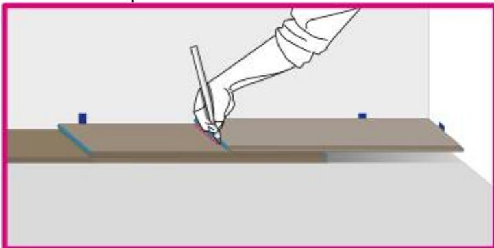
3d. Cortar la lama e instalar la sección cortada
