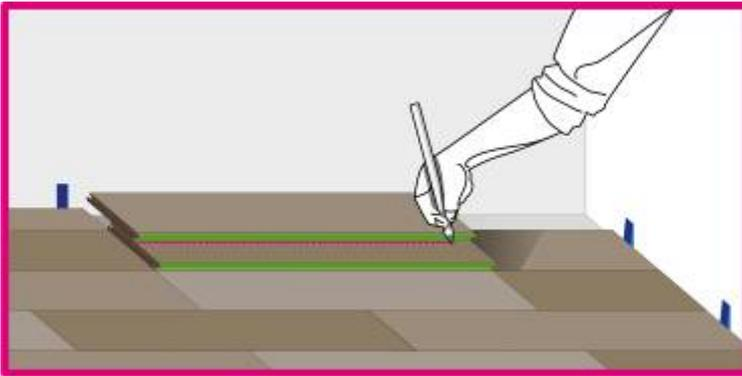
8. Para instalar una lama en las esquinas restantes: hacer un corte longitudinal, y luego un corte a lo ancho con el mismo método e insertar la lama resultante tras el corte.
