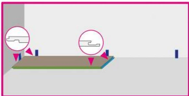
2. Coloque la segunda lama siguiendo el perímetro de la pared, insertándola en la ranura (en azul en el dibujo) de la primera tabla. Tenga cuidado de no dañar las esquinas de las lamas.
