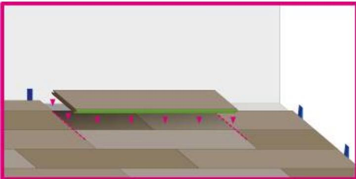
7b. Coloque otra lama en la parte superior de ésta última asegurándose de que toque la pared
