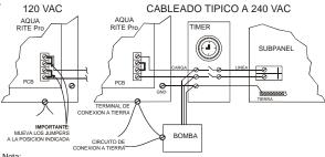
Nota: Conecte la bomba directamente al timer--no use el Aqua Rite Pro como caja de conexiones
