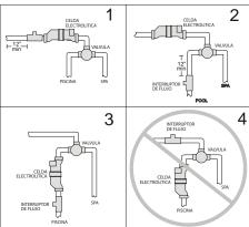
Interruptor de Flujo: IMPORTANTE: Debe haber al menos 12" (25cm) de tubería en línea recta antes (corriente arriba) del interruptor de flujo. Si el interruptor es instalado después de la celda, la celda se puede contar como las 12" (25cm) de tubería en línea recta. Para asegurar la correcta operación, verifique que la flecha en el interruptor de flujo (localizada en la parte superior de la tuerca hexagonal gris) señale en la dirección de la corriente de agua.
