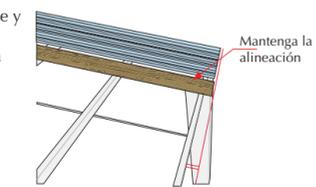
Coloque la teja siguiente de tal forma que siempre traslape lateralmente por encima la teja subyacente y asegúrela con las fijaciones según sea el caso.
