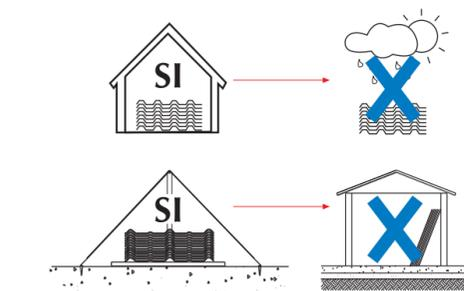
De igual forma evite el contacto de las tejas con sustancias químicas y cualquier trabajo mecánico sobre ellas. Nunca almacene o coloque materiales sobre los arrumes.
