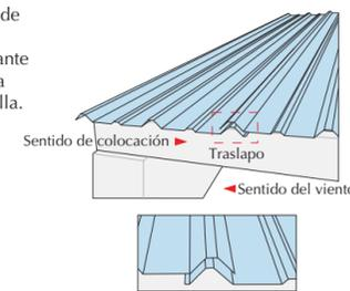
Utilice los tablones para apoyarse y fijar la primera teja, usando la fijación recomendada para cada perfil.
