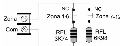
Lógicamente, en las 6 zonas de la Central NX-6 la Duplicación de Zonas, no es compatible con la función de Tamper Propio Identificado. Sin embargo, puede aplicarse la Duplicación de Zonas a las 6 zonas de la Central NX-6
