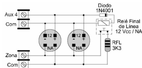
Se conectan como si fueran detectores de robo: dos hilos para alimentar los detectores y otros dos para la zona en sí. Lógicamente el margen de la tensión de alimentación de los detectores de incendio debe permitirles funcionar a 12 voltios. El relé de alarma debe ser normal abierto. La central detectará el corte del cable de zona como avería. Si también desea supervisar el cable de alimentación coloque un relé final de línea, tal como se indica en el dibujo.
