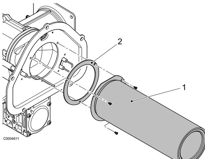
2. Soltar los tornillos y retirar el tubo del quemador (1) con la junta del tubo del quemador (2).
