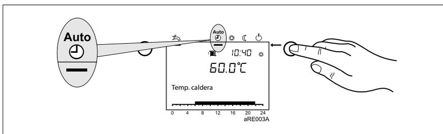
Con la tecla de Servicio de calefacción seleccionar en la unidad de mando de regulación el modo operativo **Funcionamiento automático**.
