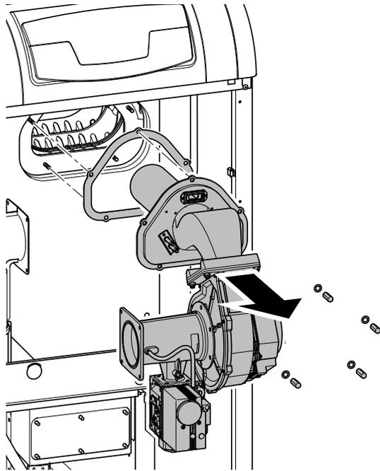
7. Retirar las tuercas y arandelas y sacar todo el quemador (5) junto con la junta del quemador (6) hacia delante.
