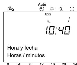
Llevar a cabo el ajuste de las horas
