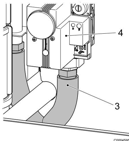
6. Soltar el tubo de conexión de gas (3) de la válvula de gas (4).
