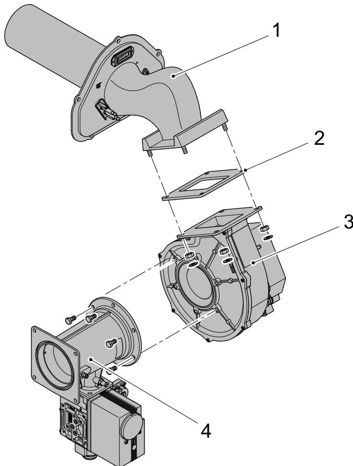
2. Retirar las tuercas con las arandelas y extraer el ventilador (3) con la junta (2) de la tapa del quemador (1).
