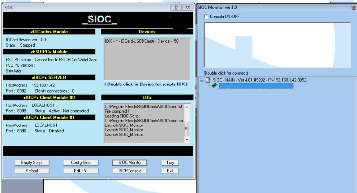
Es importante fijarse bien en el DEVICE asignado, que en nuestro ejemplo es el 50, para poder configurar y usar la tarjeta, los potenciómetros y los motores acoplados a ella.
