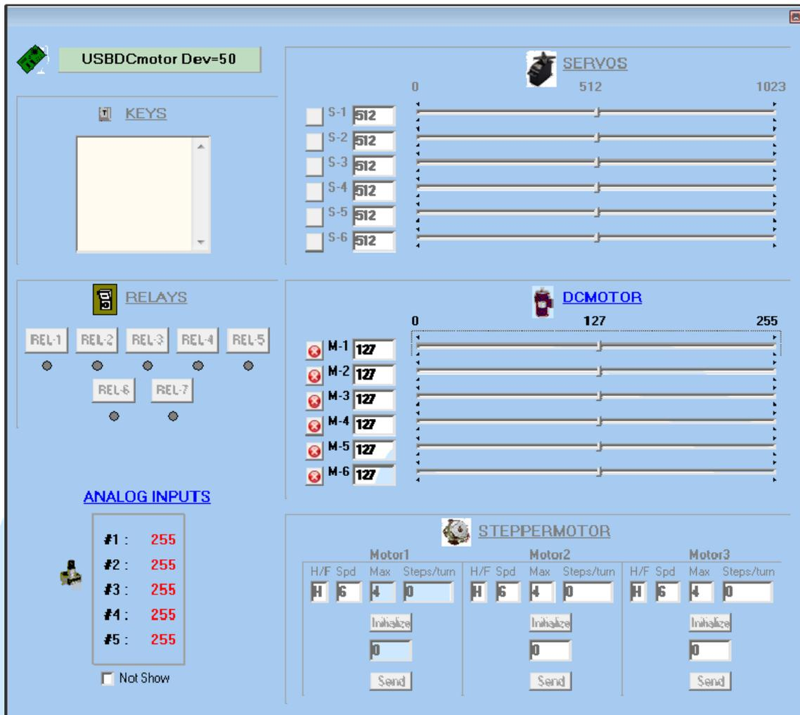
Si todo está bien conectado nuestro potenciómetro dará la lectura según su posición, podemos moverlo para ver los cambios (si las entradas analógicas oscilan mucho podemos puentear el pin central con uno de los pines contiguos de la misma entrada).
