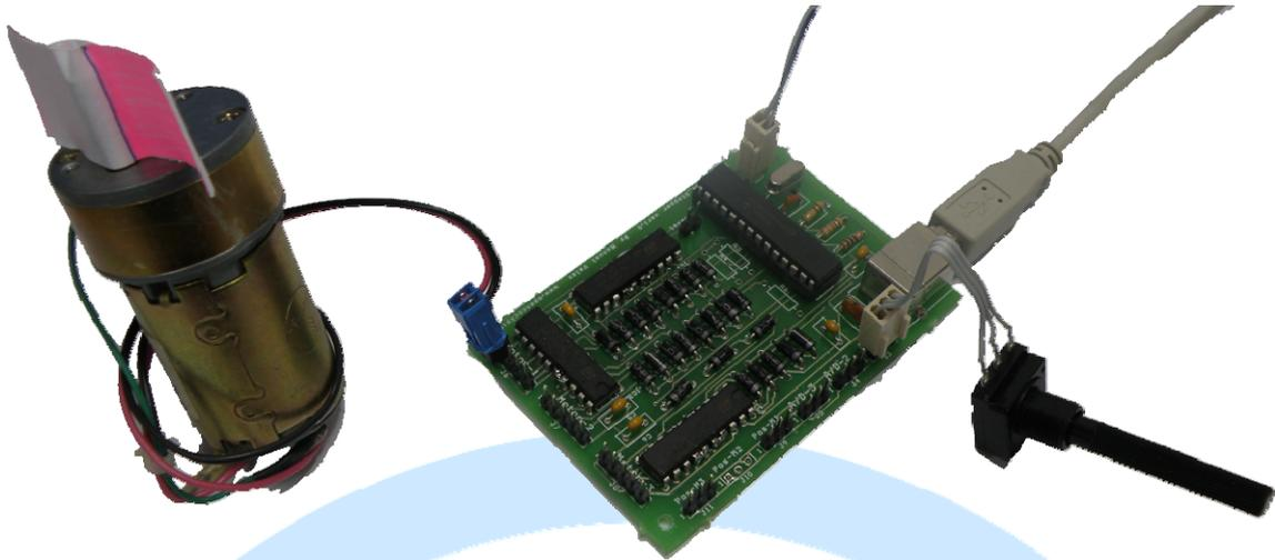
Nuestro motor de pruebas funciona a 5V, por lo que alimentaremos la tarjeta USB-DcMotors a 5V (si el motor fuera de 24V habría que alimentar la tarjeta con 24V, pero nunca más de 36V), lo conectamos a la salida J6 pin 1 y pin 2 (el sentido de giro puede cambiarse bien vía SIOC, bien vía hardware cambiando la conexión de los cables del motor). El potenciómetro lo hemos conectado a la entrada J3.
