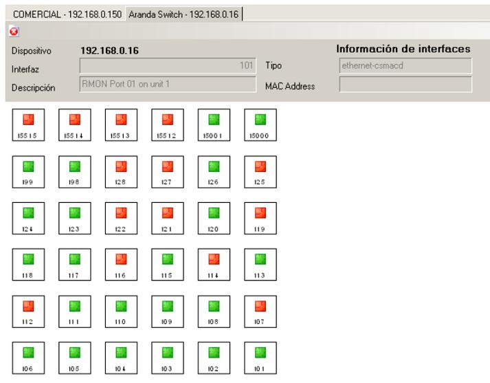
El diagrama muestra en *verde* las interfaces activas, en *amarillo* las interfaces en prueba y en *rojo* las interfaces inactivas.
