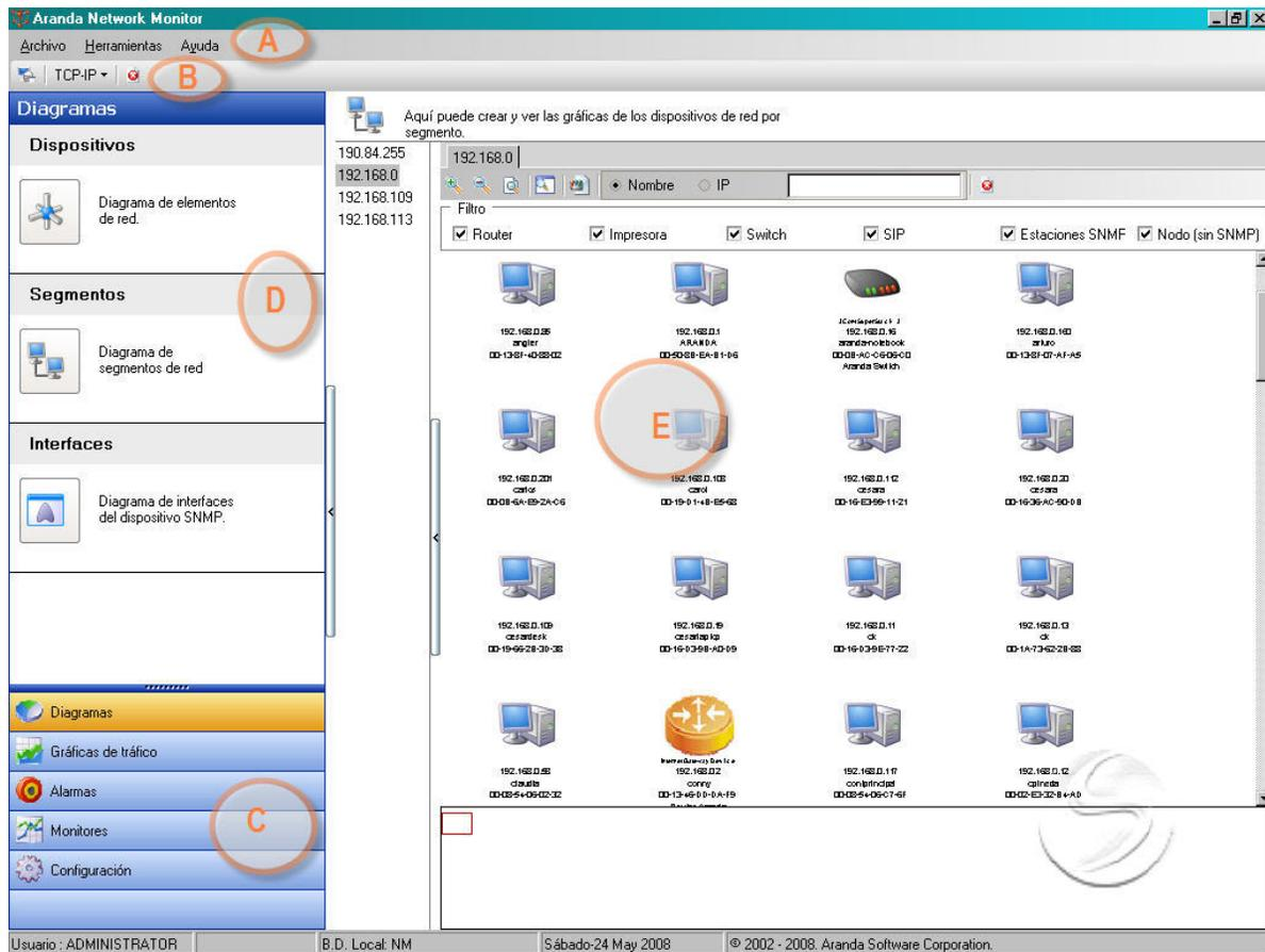
ANM cuenta en su interfaz principal con una barra de herramientas (A) y una barra de iconos (B) en la parte superior, y un panel (C) con ventana retraible (D) en la parte izquierda. Desde la barra de herramientas puede acceder rápidamente a las mismas, tanto de la barra de iconos como del panel.
