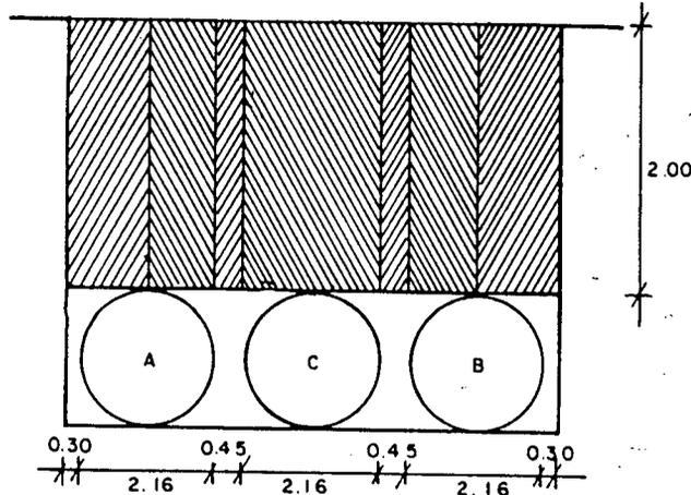
Determinar la clase de tubería que se debe utilizar si se van instalar con una cimentación Clase B, y el relleno se hará con mezcla de arena y grava.
