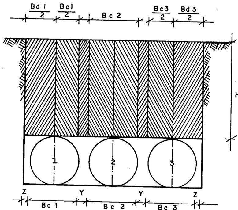
Analizando la tubería del centro primero, se nota que si el diámetro exterior del tubo ( $Bc2$ ) más el espacio entre los tubos adyacentes ( $2Y$ ) es igual o mayor que el ancho de transición para el ancho del tubo y la profundidad del relleno ( $H$ ) sobre el lomo del mismo, entonces el tubo 2 está en condición de proyección positiva.
