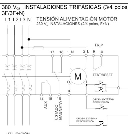
La alimentación del motor tiene que ser externa a la instalación a proteger (maniobra) o engancharse de la entrada del magnetotérmico motorizado. En ningún caso tiene que engancharse de la salida del magnetotérmico motorizado.
