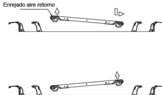
Conforme a la figura mostrada con la dirección de la flecha, presione sobre un lado del filtro para desprenderlo. Haga la misma acción para desprender el otro lado del filtro. Limpie el filtro.
