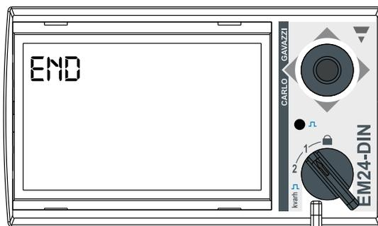
9. Volver a elegir la posición de bloqueo mediante el selector.
