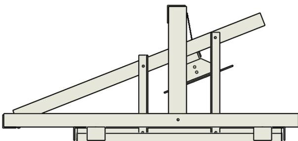
Si al subir el motor el soporte para antes de que el marco blanco active el paro con el switch, el sistema de paro del motor está operando antes que el switch y debe ajustarlo para que sea el switch que haga el paro al pegar el marco blanco en el switch. Realice el
