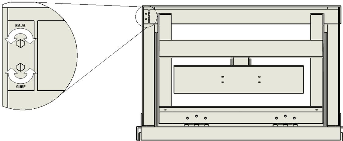
Si el motor sigue girando después de que el soporte bajo a su posición, antes de hacer el ajuste debe subir el Skydoor®, de lo contrario puede dañar el sistema de paro.
