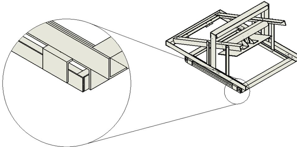
Cada uno de los soportes laterales tiene una goma plástica para amortiguar la vibración del soporte. Si no están puestas en los soportes deslizantes búsquelas en la caja del empaque y colóquelas en los soportes deslizantes.
