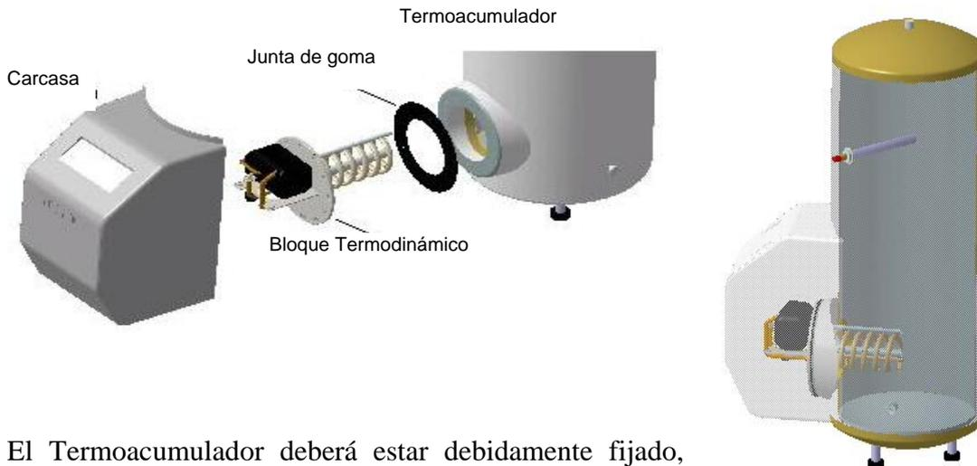
El Termoacumulador deberá estar debidamente fijado, antes de la colocación del Bloque Termodinámico, evitando así el volcamiento del conjunto, ya que existirá un descentramiento del centro de gravedad de este.
