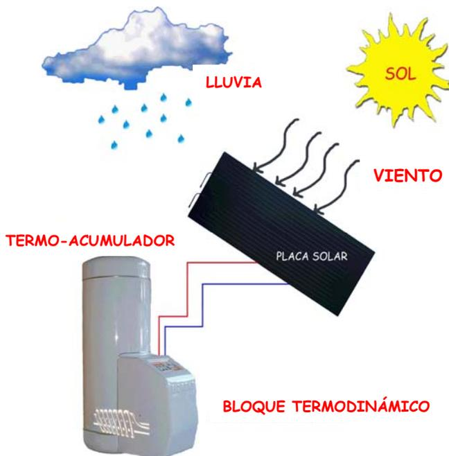
El compresor aspira el vapor del panel y lo comprime, elevando la presión y la temperatura del gas, que es transmitida al depósito de agua mediante un intercambiador de calor, dicho intercambiador se encuentra acoplado en el interior del depósito acumulador.
