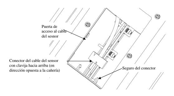
Figura 1 Remoción del Conector del Cable del Sensor
