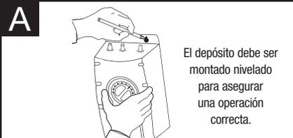
El depósito debe ser montado nivelado para asegurar una operación correcta.
