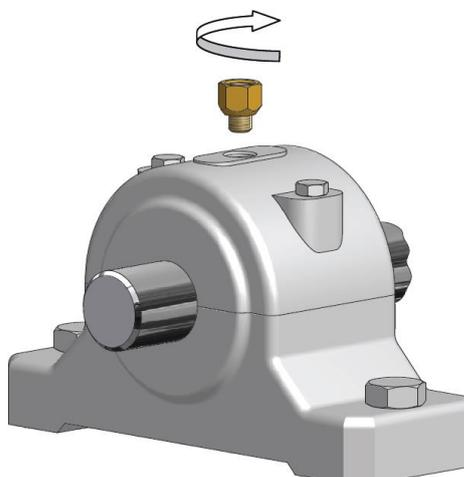
④ Prelubricar el punto de lubricación, todas las conexiones y tubos flexibles.
