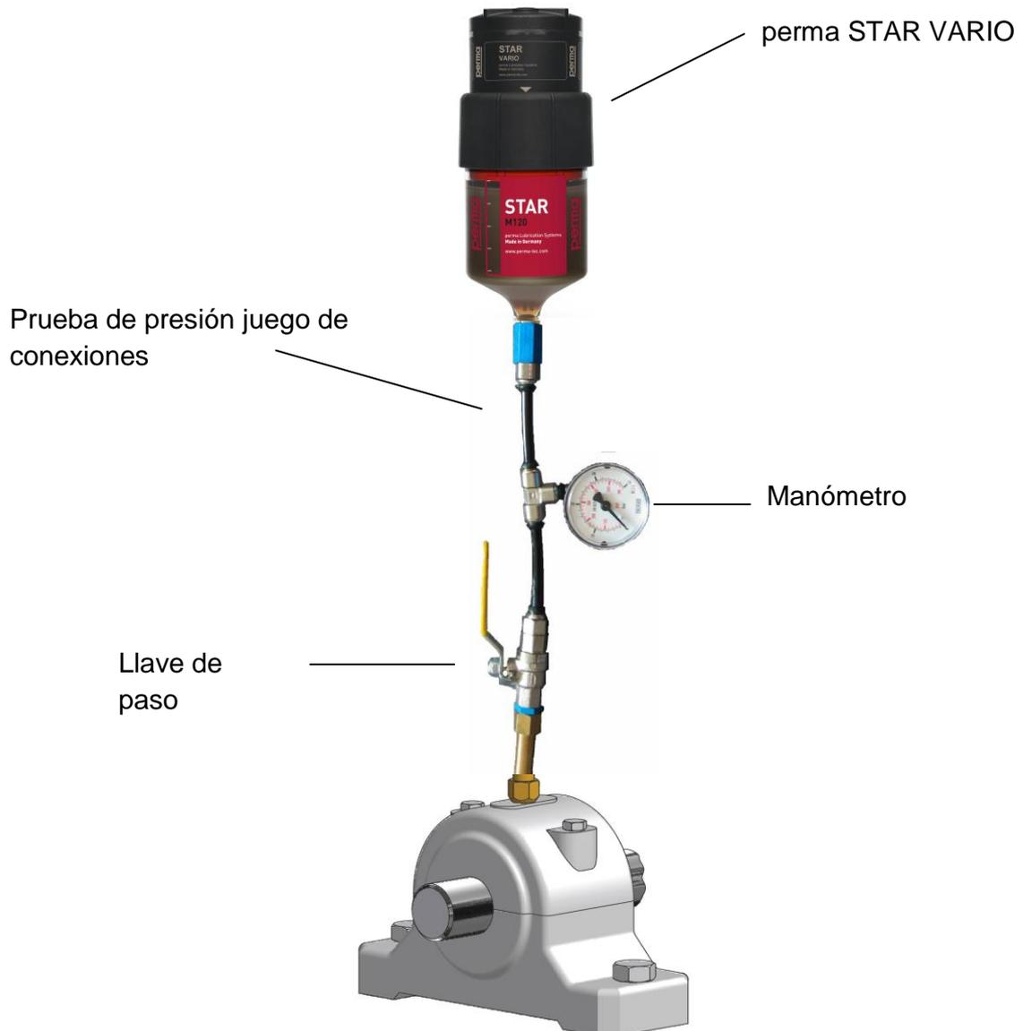
Para la prueba de presión puede usar perma STAR VARIO en combinación con el juego de conexiones (101480).
