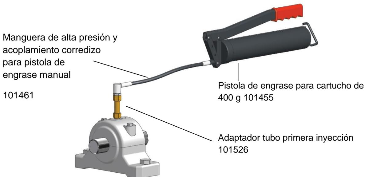
En montaje a distancia rellenar previamente con lubricante el punto de lubricación y tubos flexibles
