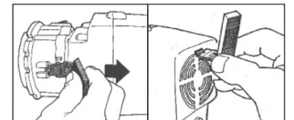
6 Reinstale la tapa del cabezal, conecte el frente de los sujetadores al reborde de la tapa y luego presiónelos para fijarlos. **Ilustración K**
